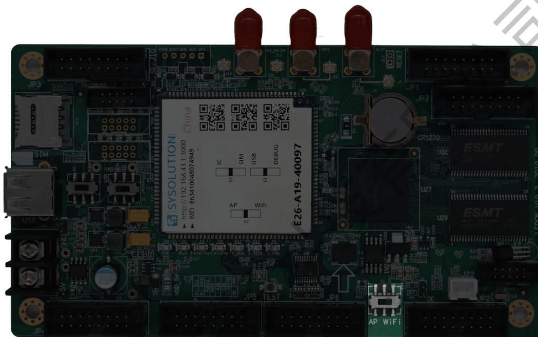
2. 点击手机设置界面, 打开无线局域网, 找到控制卡释放的 AP 热点 (WiFi 名称格式: E26-XXX-XXXXX), 点击输入密码进行连接。(默认密码为 12345678)
